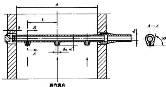
注:  $L \approx 0.433 d$ ;  $d_1 = 10 \text{ mm} \sim 15 \text{ mm}$ ;  $d_2$  一般为  $3 \text{ mm} \sim 4 \text{ mm}$ 。
